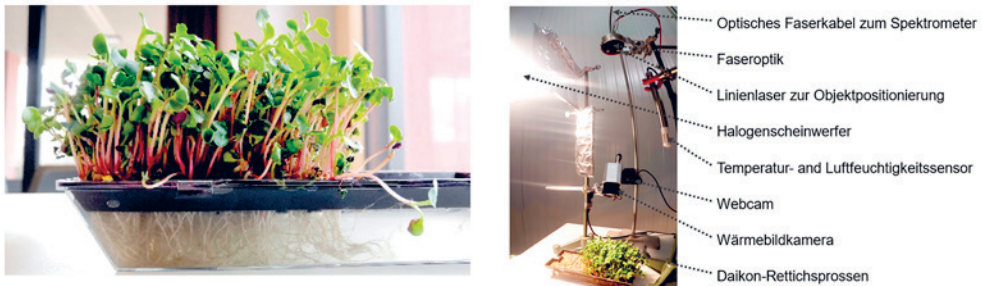
Abb. 2: Auf einem Gitter gezüchtete Daikon-Rettichsprossen mit darunterliegendem Wasserreservoir (links); Versuchsaufbau in der Klimakammer (rechts).
