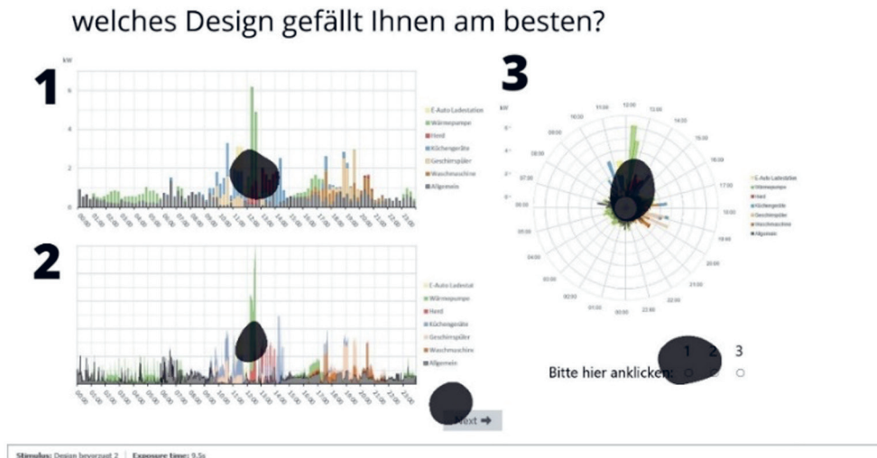
Abb. 4: Shadow Map zur Visualisierung vom Tagesverbrauch (dunkel markierte Bereiche wurden am häufigsten fixiert), n=50
