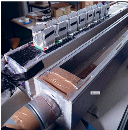
Abb. 4a: erstes Demonstrationsgerät mit 8 TEE und Aluminiumkühlkörpern
