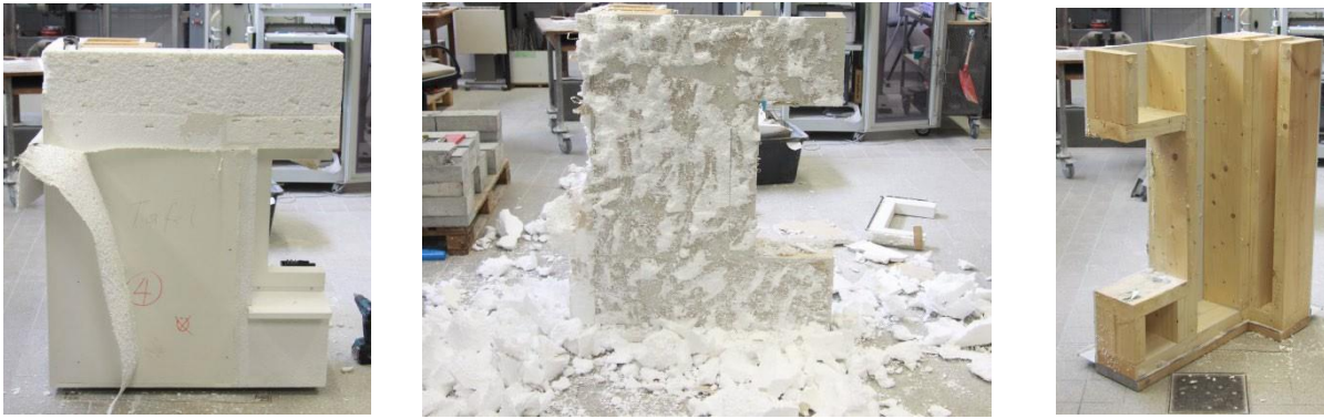
Abb. 1: Rückbau und Trennbarkeitsversuche an Bauteilen aus der Holzfertigbauweise im Labor mit Polystyrol-Dämmung.
